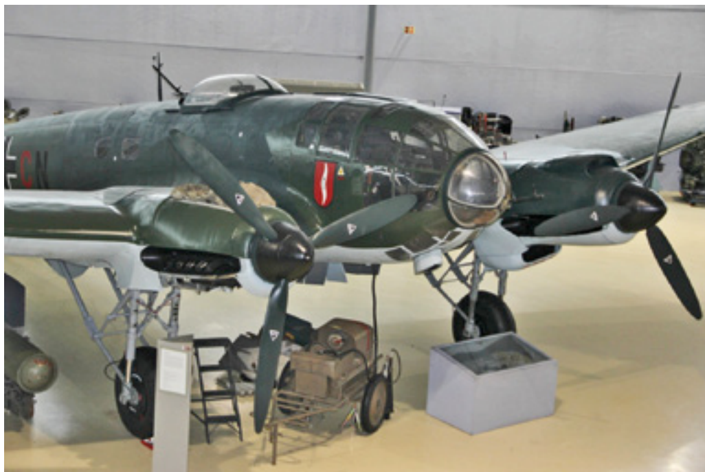
Nově zrestaurovaný Heinkel He 111P v leteckém muzeu Oslo-Gardermoen. Dvanáctiválcové motory DB 601 s elektricky stavitelnou, třílistou vrtulí zn. VDM 9-11081-C zcela totožnou s nálezem torza vrtulového listu u Bečova (vpravo) byly charakteristickým znakem nepočetné série Heinkelu He 111 varianty P.
