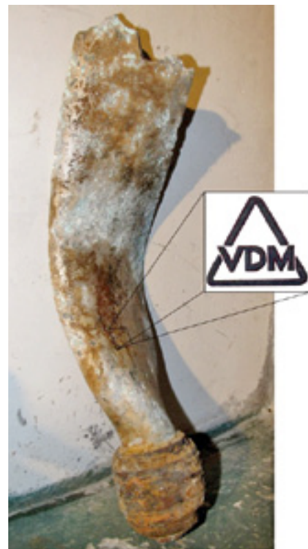
Nově zrestaurovaný Heinkel He 111P v leteckém muzeu Oslo-Gardermoen. Dvanáctiválcové motory DB 601 s elektricky stavitelnou, třílistou vrtulí zn. VDM 9-11081-C zcela totožnou s nálezem torza vrtulového listu u Bečova (vpravo) byly charakteristickým znakem nepočetné série Heinkelu He 111 varianty P.
