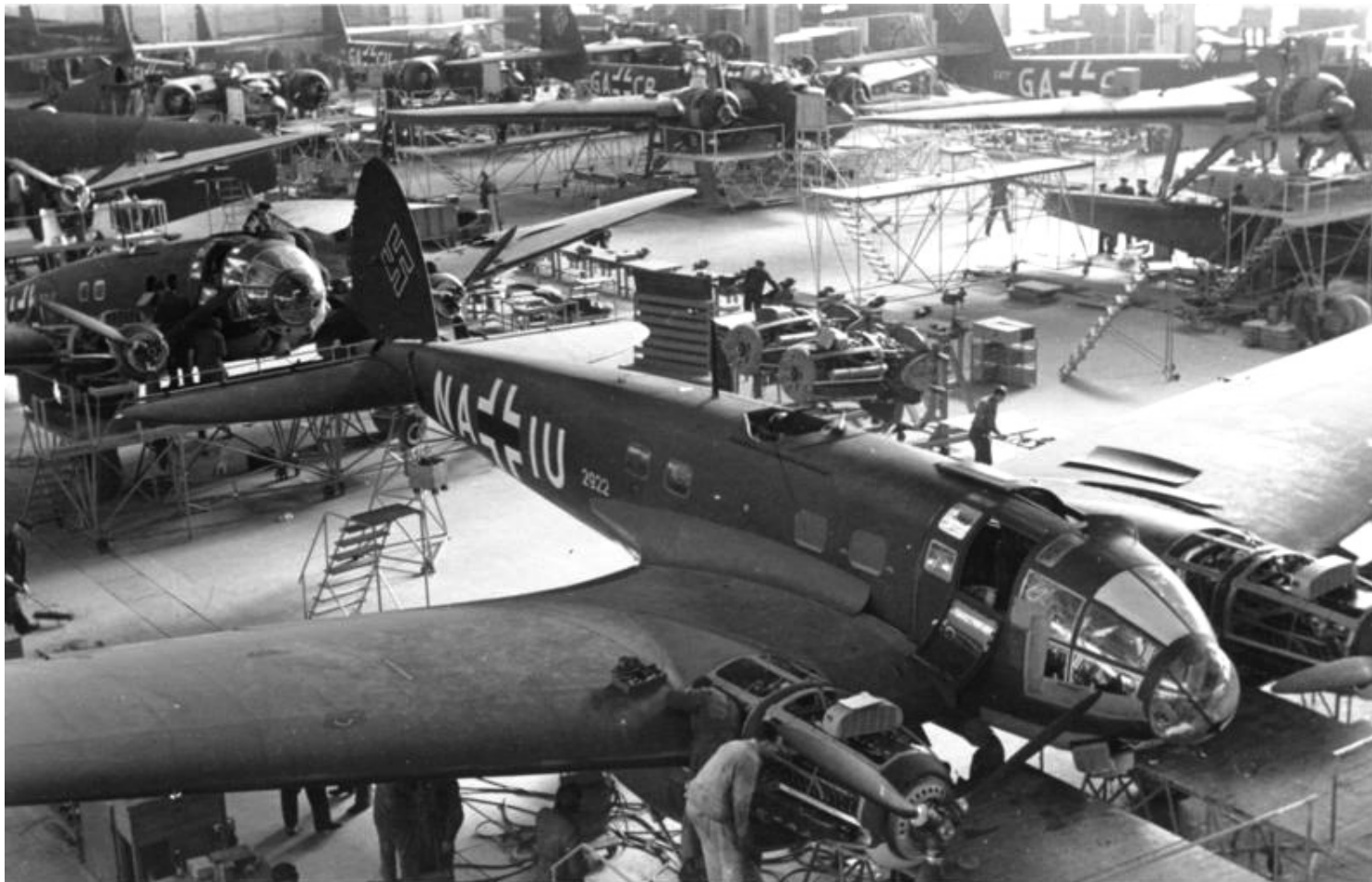
Sériová výroba He 111 verze P v tovární hale v Ernst Heinkel Flugzeugwerke v Rostock- Marienehe, záběr na stroj výr.č. 2922 s již namalovaným kódem NA+IU je z přelomu roku 1939/40.
